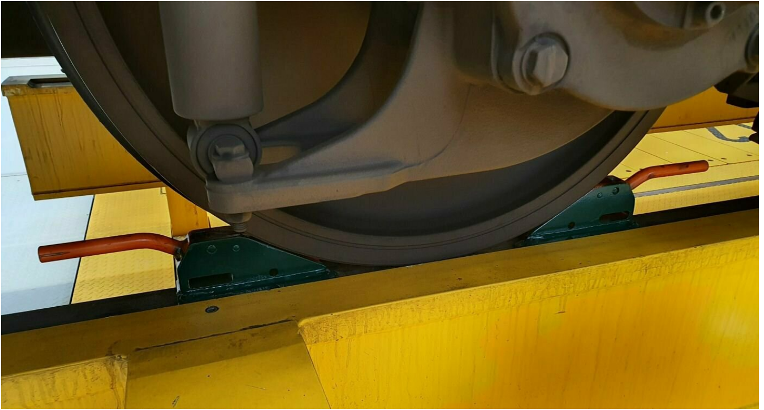
Zwei Radstopper auf der Unterflurhebeanlage im Einsatz.
